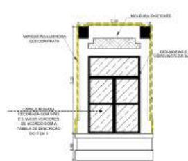
DETALHE JANELA 3º PAV. ESCALA 1/50
